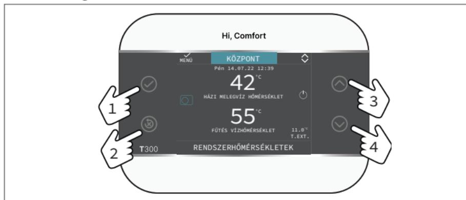
Az alábbiakban ismertetett négy oldalsó nyomógomb segítségével könnyedén elvégezheti a készülék programozásához és testreszabásához szükséges összes műveletet.
