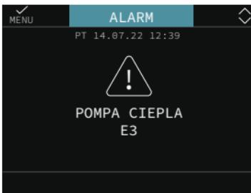
Niektóre nieprawidłowości resetują się same (patrz instrukcja pompy ciepła). Aby przywrócić działanie pompy ciepła, należy odłączyć i ponownie przyłączyć zasilanie elektryczne. Jeśli błąd będzie się powtarzać, należy skontaktować się z Serwisem technicznym.
