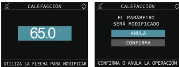
Si se instala una sonda externa, el valor de la temperatura de impulsión es elegido automáticamente por el sistema en función de la curva de termorregulación configurada en el parámetro
