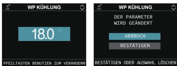
Wenn die Temperaturregelung im Kühlmodus aktiviert ist, wird der Wert der Vorlauftemperatur automatisch vom System gemäß der eingestellten Kurve gewählt, wodurch die Raumtemperatur schnell an die Veränderungen der Außen-temperatur angepasst wird.
