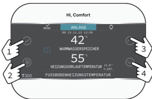
Mit den vier seitlichen Tasten, die im Anschluss beschrieben werden, können Sie problemlos alle für die Programmierung und Anpassung des Geräts erforderlichen Vorgänge durchführen.
