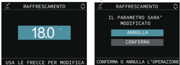
Se è attivata la termoregolazione in raffrescamento il valore della temperatura di mandata viene scelto automaticamente dal sistema in base alla curva impostata, che provvede ad adeguare rapidamente la temperatura ambiente in funzione delle variazioni della temperatura esterna.
