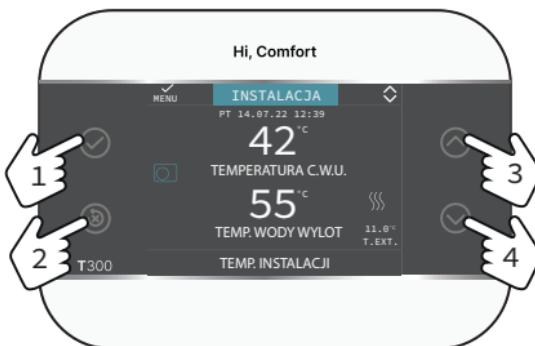
Opisane poniżej cztery boczne klawisze pozwalają w łatwy sposób wykonać wszystkie czynności niezbędne do zaprogramowania i dostosowania urządzenia.
