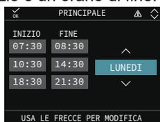
Con pompa di calore sono disponibili due programmazioni orarie: una per l'inverno ed una per l'estate. Selezionare la stagione desiderata (ESTATE o INVERNO) dal MENU/STATO/SISTEMA e procedere successivamente alla programmazione del parametro SANITARIO PDC per ciascuna stagione.
