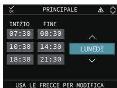
Con pompa di calore sono disponibili due programmazioni orarie: una per l'inverno ed una per l'estate. Selezionare la stagione desiderata (ESTATE o INVERNO) dal MENU/STATO/SISTEMA e procedere successivamente alla programmazione del parametro SANITARIO PDC per ciascuna stagione.
