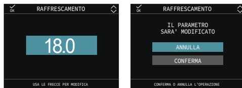
Se è attivata la termoregolazione in raffreddamento il valore della temperatura di mandata viene scelto automaticamente dal sistema in base alla curva impostata, che provvede ad adeguare rapidamente la temperatura ambiente in funzione delle variazioni della temperatura esterna.
