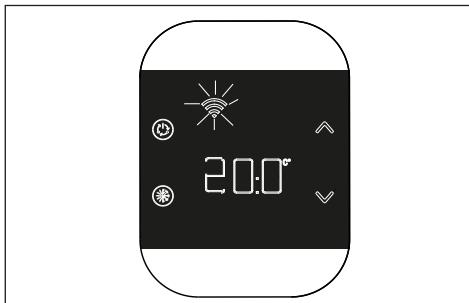
Si el ícono "WiFi" está apagado, el procedimiento ha fallado y hay que repetir el desacoplamiento.
