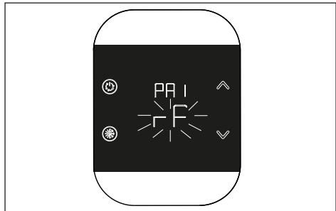
Si el procedimiento tiene un resultado positivo, aparece el mensaje OK en el T300 y en el T200 pasa de forma automática a la pantalla operativa y el ícono "WiFi" queda encendido; por el contrario, si el procedimiento no se completa correctamente, en el T300 aparece el mensaje KO mientras que en el T200 la pantalla muestra RTF (Reset To Factory) con la correspondiente indicación rF que indica que el emparejamiento
