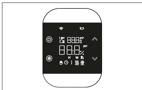
Una vez finalizada la prueba de iconos, la versión del firmware del T200 aparece en la pantalla durante unos segundos. La primera línea identifica la revisión del módulo RF (ej: 6.0), y la segunda línea el FW Host del objeto (ej: S01).
