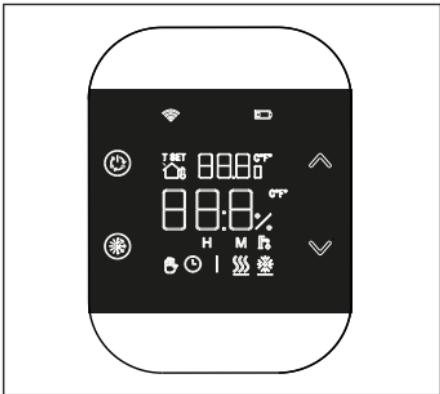
Po zakończeniu testu ikon na wyświetlaczu na kilka sekund pojawi się wersja oprogramowania sprzętowego T200. Pierwsza linia identyfikuje wersję modułu RF (np.: 6.0), natomiast druga linia identyfikuje oprogramowanie hosta obiektu (np.: S01).
