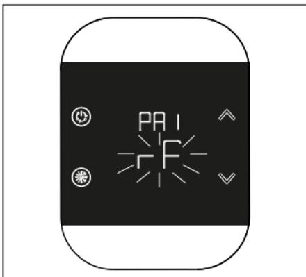
Ha az eljárás sikeres, az OK üzenet jelenik meg a T300-on, miközben a kijelző automatikusan átvált a T200 kezelőképernyőjére és a „” bekapcsolva marad; ha az eljárást nem fejezték be megfelelően, a KO üzenet jelenik meg a T300-on és a T200 kijelzőjén az RTF (Reset To Factory) üzenet látható, a megfelelő RF kijelzővel pedig azt jelzi, hogy a párosítás sikertelen volt.
