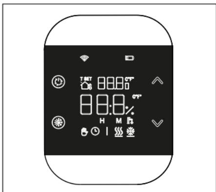
Una vez finalizada la prueba de íconos, la versión del firmware del T200 aparece en la pantalla durante unos segundos. La primera línea identifica la revisión del módulo RF (ej: 6.0), y la segunda línea el FW Host del objeto (ej: S01).
