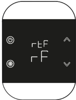
El desacoplamiento se ha realizado correctamente si el T200 muestra la pantalla principal durante unos segundos y después la pantalla con “” parpadeando. Esto indica que se puede volver a acoplar.
