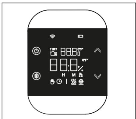
Terminato il test icona sul display appare per qualche secondo la versione firmware del T200. La prima riga identifica la revisione del modulo RF (es.: 6.0), mentre la seconda riga del FW Host dell'oggetto (es.: S01).
