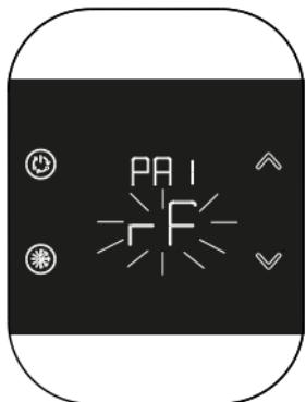
Se la procedura ha esito positivo, sul T300 compare il messaggio OK mentre sul T200 la visualizzazione passa automaticamente alla schermata operativa e l'icona “” rimane accesa; contrariamente, se la procedura non si conclude correttamente, sul T300 compare il messaggio KO mentre sul T200 il display mostra RTF (Reset To Factory) con la relativa visualizzazione “RF” ad indicare che l'accoppiamento non è avvenuto.
