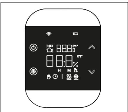
Odată ce testul simbolurilor este finalizat, versiunea de firmware a T200 apare pe ecran pentru câteva secunde. Prima linie identifică revizia modulului RF (de exemplu: 6.0), în timp ce a doua linie identifică FW Host-ul obiectului (de exemplu: S01).
