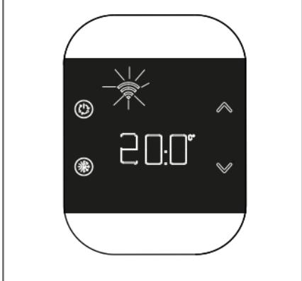
Si el ícono “” está apagado, el procedimiento ha fallado y hay que repetir el desacoplamiento.
