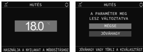
Ha a hűtésben a hőszabályozás aktiválva van, akkor a beállított görbe alapján a rendszer automatikusan kiválasztja a szállítási hőmérséklet értéket, amely gyorsan beállítja a helyiség hőmérsékletét a külső hőmérséklet változásai alapján. Ha módosítani szeretné a hőmérsékleti értéket, növelve vagy csökkentve az elektronikus kártya által automatikusan kiszámított értékhez képest, akkor a HÜTÉS alapelelet módosíthatja a kívánt komfortfokozat kiválasztásával a (-5 ÷ +5) tartományon belül.
