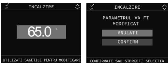
Dacă este instalată o sondă externă, valoarea temperaturii de tur este aleasă automat de către sistem pe baza curbei de termoreglare setată în parametrul dedicat, care reglează rapid temperatura camerei în funcție de variațiile temperaturii exterioare. Dacă dorîți să modificați valoarea temperaturii, crescând-o sau scăzând-o față de cea calculată automat de placă electronică, puteți modifica valoarea de referință ÎNCĂLZIRE alegând nivelul de confort dorit în interval (-5 ÷ +5).
