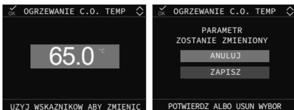
Gdy zainstalowany jest czujnik temperatury zewnętrznej, system automatycznie wybiera temperaturę na wylocie, który szybko dostosowuje temperaturę otoczenia do zmian temperatury zewnętrznej. Jeżeli chcemy zmienić temperaturę, podwyższyć ją lub obniżyć w stosunku do automatycznie wyliczonej przez płytke elektroniczną, istnieje możliwość zmiany nastawy OGRZEWANIA wybierając żądanego poziom komfortu w zakresie (-5 Do +5).
