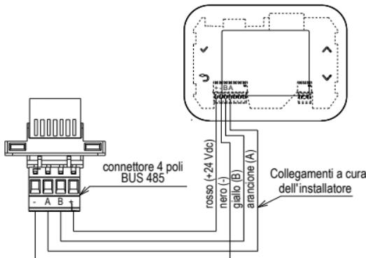
per ulteriori schemi elettrici di collegamento a pompe di calore riferirsi al manuale completo scaricabile, vedi info pag. 2
