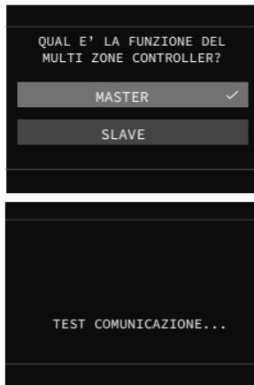
Dopo aver selezionato l'opzione **MASTER**, attendere qualche secondo perchè il T300 effettui il test di comunicazione con la caldaia.
